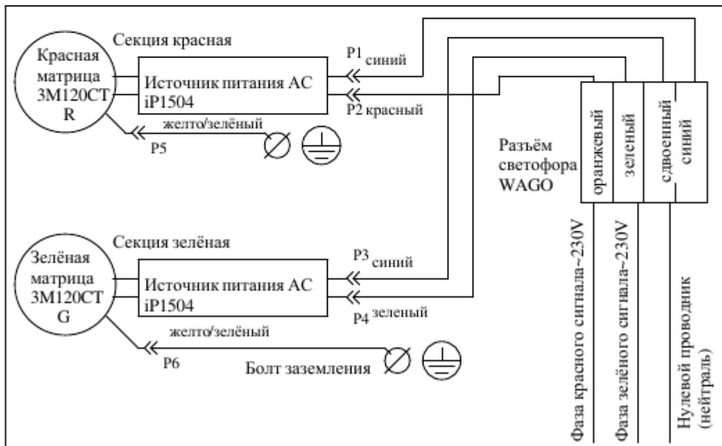
Порядок отключения проводников от ИП секции - сначала размыкаются сигнальные разъёмы P1,P2,P3,P4. Затем размыкаются разъёмы заземления P5,P6.
